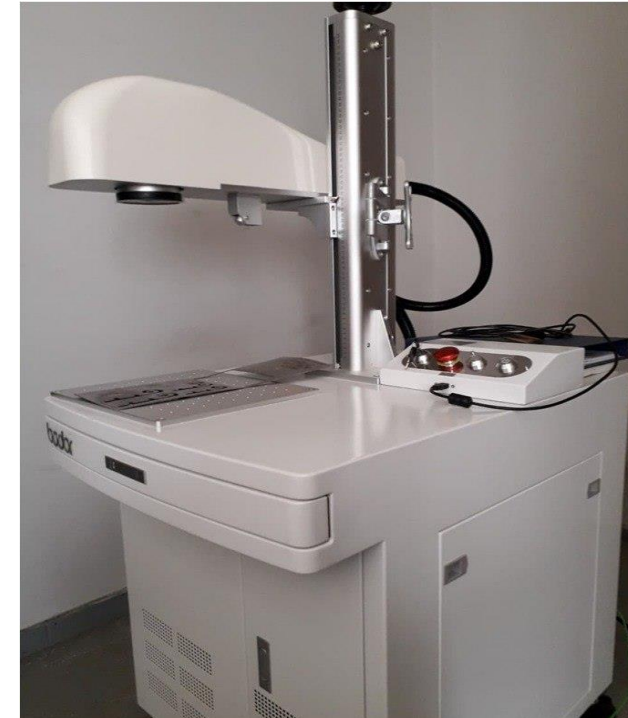
Лазерний маркер Bodor Laser BML – 30W
