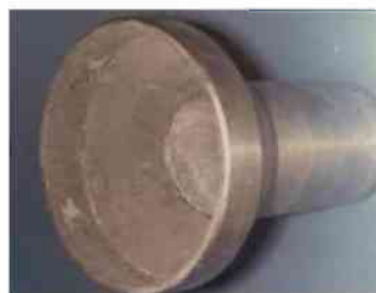
Насадка для пальників: \varnothing - 300; 600; 930 мм; висота - 600 мм; товщина стінки - 15...20 мм
