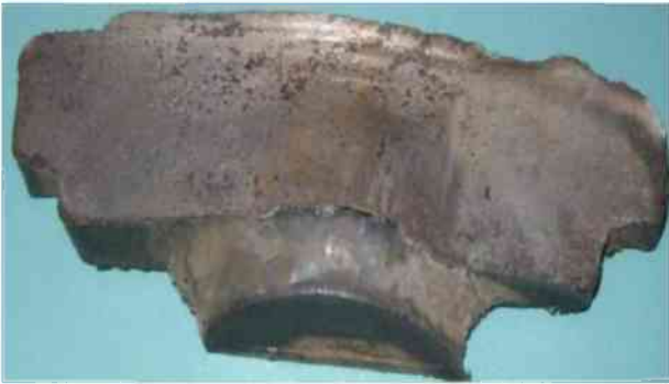
Фрагмент зламаної провушини деталі «Кронштейн кріплення задньої ресори» вантажного автомобіля Рено
